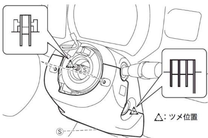
■ステアリングコラムカバーを止めているビスを外し、コラムカバーを外します。
