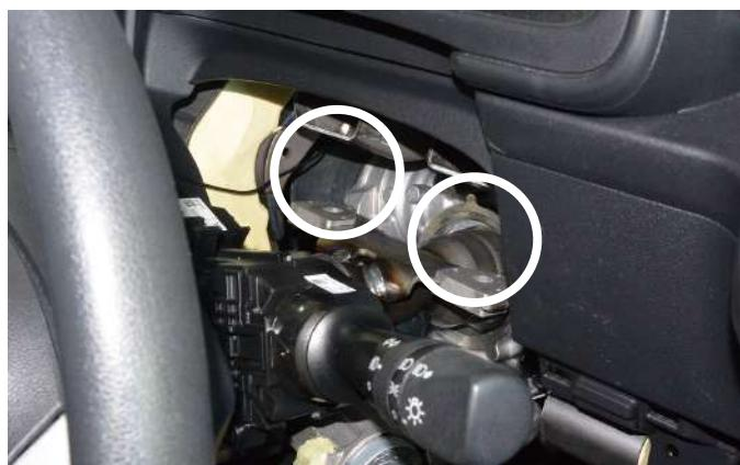
■ステアリングコラムを締結している左図上側の○で囲んだボルトを取り外します。
