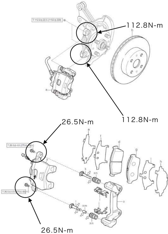
■取り付けは逆の手順で行います。ブレーキパッドの残量インジケータはピストン側で上側です。
