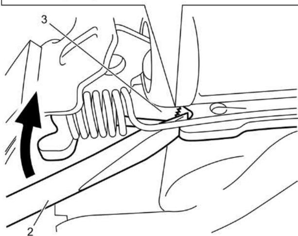
■取り付けは逆の手順で行います。ブレーキシューが広がっていてブレーキドラムの取り付けが困難な場合はパーキングブレーキの調整機構を使って取り付けてください。
