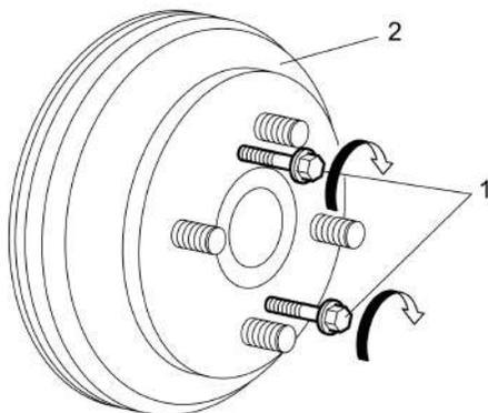
■ブレーキドラムをリアハブから取り外します。固着している時は2箇所
