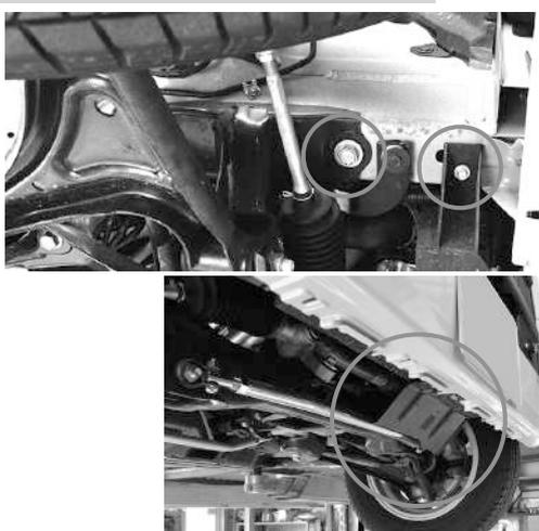
■コアサポートを止めているM6ボルトとフロントサスペンションメンバーの前側の2本のM14ボルトを取り外します。
