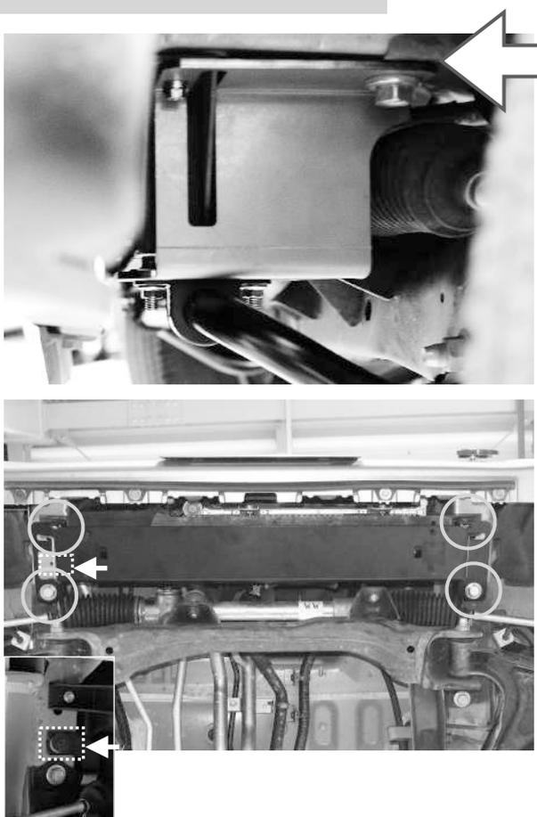
■助手席側のサスペンションメンバーとの間にスペーサープレートを挟みサポートメンバーを取り付けます。
