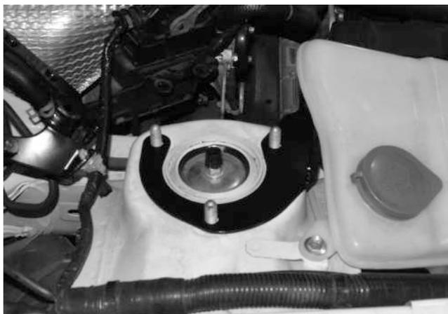
■ウインドウウォッシャータンク後方にダンパー取り付け部が来るようフロントサスペンションアッパーマウント部にボディ側ステアを取り付けます。
