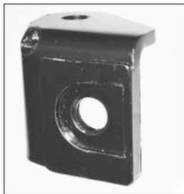
■シリンダヘッドの右側前方のボルト穴を使用しエンジン側ステーを取り付けます。
