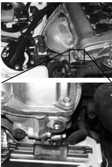
■シリンダヘッドの右側前方のボルト穴を使用しエンジン側ステーを取り付けます。エンジン側ステーの凹部をシリンダヘッドに嵌合するように取り付けます。6.のキャップボルトセットを使用してください。
