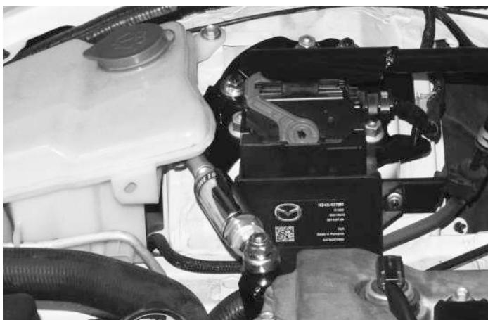
■ボディ側のステーの前方、エンジン側ステーの上側にダンパーをボタンキャップボルトとナイロンロックナットで取り付けます。
