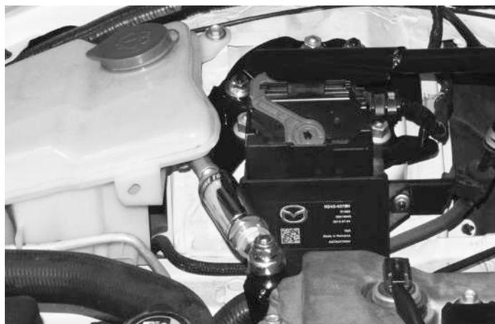
■ボディ側のステアの前方、エンジン側ステアの上側にダンパーをボタキャップボルトとナイロンロックナットで取り付けます。
