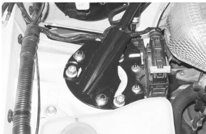
■右フロントサスペンションアッパーマウント部のナットを全て外してストラットバー（装着車のみ）・ステフナープレートを取り外します。
