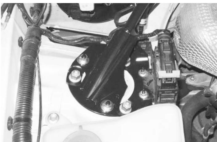
■右フロントサスペンションアッパーマウント部のナットを全て外してストラットバー（装着車のみ）・ステンナープレートを取り外します。
