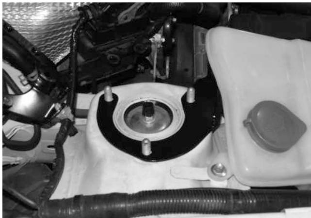
■ウインドウウォッシャータンク後方にダンパー取り付け部が来るようフロントサスペンションアップーマウント部にボディ側ステーを取り付けます。
