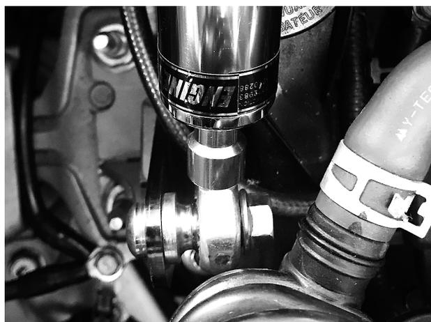
■エンジン側ステーの車体内側方向にダンパーのロッドエンドが来るようにステーとロッドエンドの間にカラーを挿入し ボタンキャップボルトL40とピロから、ナイロンセルフロックナットを使用してダンパーを取付けます。
