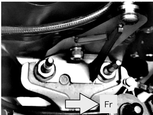
■エンジン側ステーをエンジンマウントのボルトに通し、純正ナットとキャップボルトM10×L20と平ワッシャーM10で固定します。
