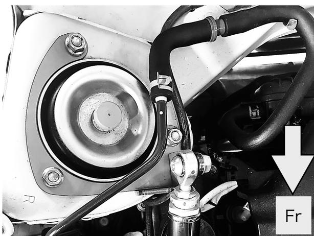
■タイヤが接地した状態でアップアマウントのナットを取り外しボディ側ステーを取付けます。
