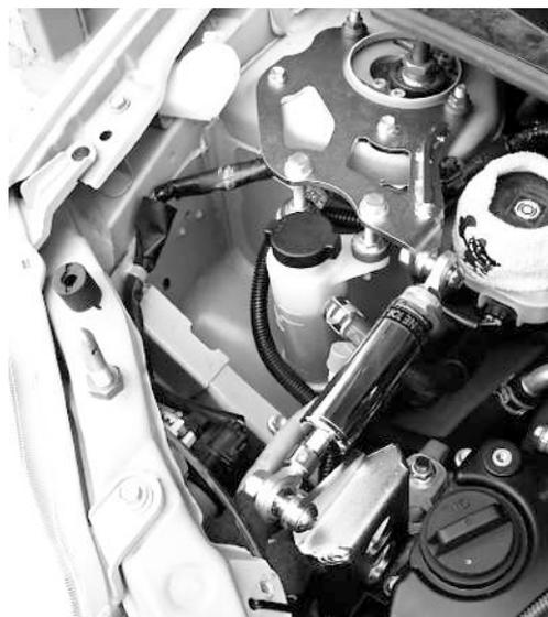
■フロントタイヤを接地させた状態でストラットアップアマウントのボルト、パワーステアリングのリザーバタンクを取り外します。
