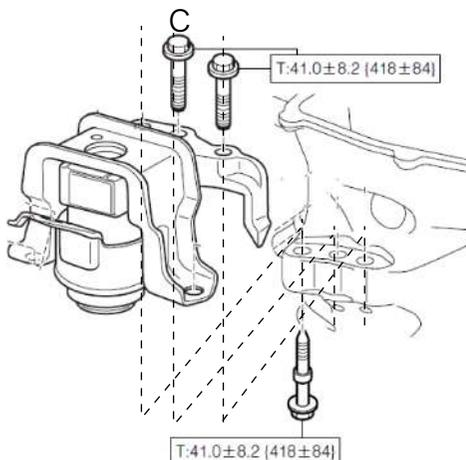
運転席側のエンジンマウントの下方から取り付けられているボルトをキットの中のキャップボルトにスプリングワッシャーとプレートワッシャーを取り付けたものと交換します。
