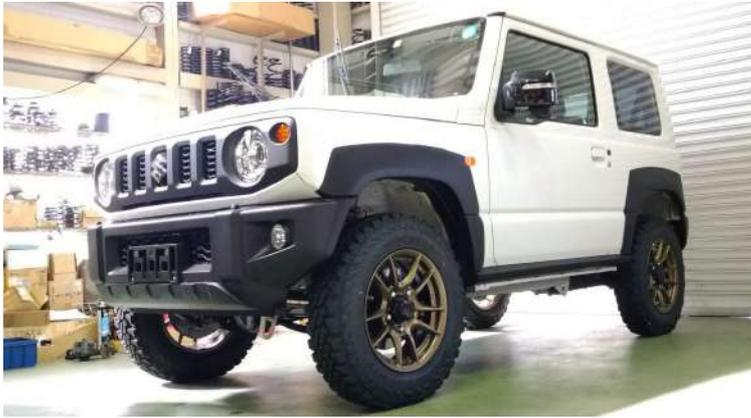
1970年の誕生以来、伝統の強固なラダーフレームをもつ本格的軽クロスカントリーの代表、スズキジムニー(JIMNY)エンジンは660cc 直列3気筒DOHC、ジムニー専用チューニングしたR06A型ターボエンジンを搭載。「新開発ラダーフレーム」に、「FRレイアウト」、「副変速機付パートタイム4WD」、「3リンクリジッドアクスル式サスペンション」というジムニー伝統の車体構成を継承。「ブレーキLSDトラクションコントロール」を全車に標準装備し、高い走破性能を実現した。
