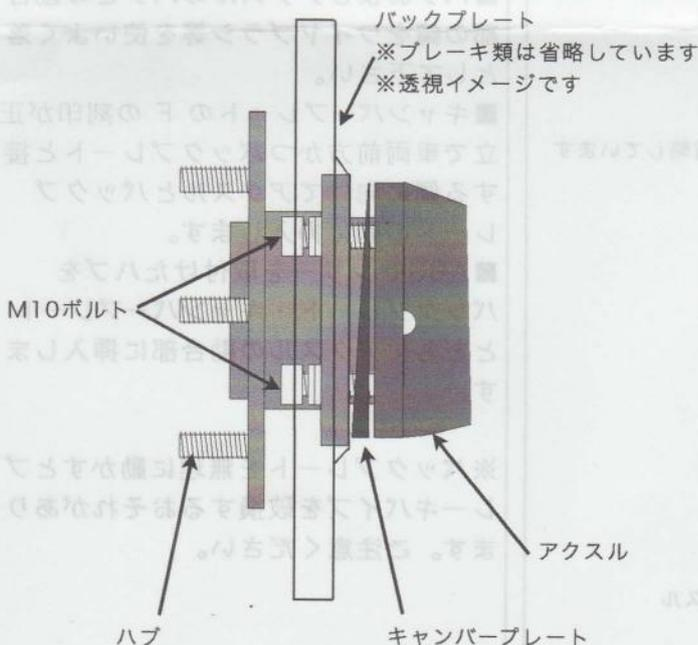
■締め付けが完了したらドラムを装着する前にサイドブレーキレバーを事前に確認した引き代までゆっくり引き上げ低頭ボルトとサイドブレーキのリリースレバーが干渉していないことを確認して下さい。
