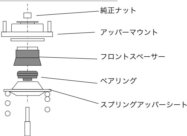
■ フロントストラット/リアリーフスプリング式リジットアクスルの構成です。フロントストラットとアッパーマウントの脱着が必要です。リアはリーフスプリングの脱着及びリーフスプリングの分解とリーフの追加が必要です。
