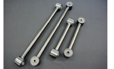
【リアコントロールアーム】 強化ブッシュ圧入済。 アッパー/ロアアームセット。
