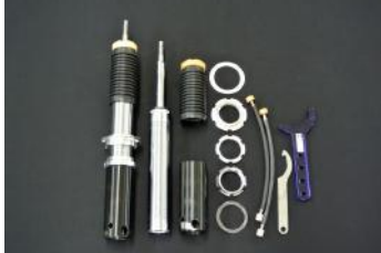
【汎用RMキット】 フロントストラットを全長式にするキット。 ダンパーの種類も豊富に用意しています。
