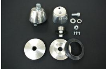
【リアピロアッパーマウント】 10φ/12φシャフト用の二種設定。 ピロボールはNMB製使用。補修も可能です。
