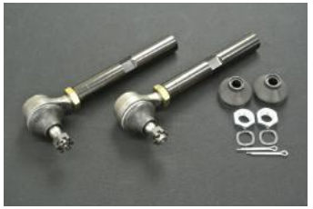
【タイロッドエンド】 太軸パイプのタイロッドエンド。 STDとLONGの二種設定。 交換用補修ブーツ付。
