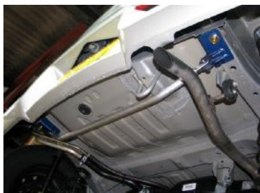
[モノコックバー リア] KAWAI WORKS製品。 左右フレームを繋ぎます。
