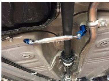
[モノコックバー センターB(4WD)] KAWAI WORKS製品。 左右フレームを繋ぎます。純正交換。
