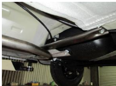
[モノコックバー センターB(2WD)] KAWAI WORKS製品。 左右フレームを繋ぎます。純正交換。
