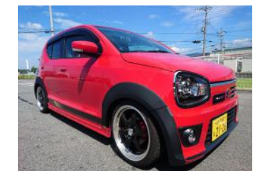
[フェンダーエクステンション] ワイドフェンダーキット。最大18mmワイド になります。ABS製。ソリッド黒/シボ黒の 二種類設定。
