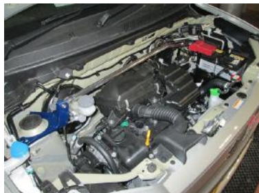
[ストラットタワーバー フロント] KAWAI WORKS製品。 左右ストラットマウントを繋ぎます。 NA専用
