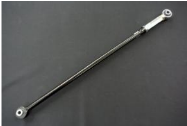
[ラテラルロッド調整式] 車高変更によりずれてしまうアクスルの 左右のスレを補正可能です。ターンバック ル調整、強化ゴムブッシュ仕様。
