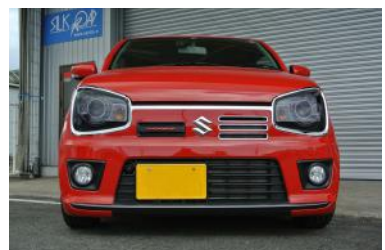
[ヘッドライトカバー] 付属両面テープで貼付けるだけの簡単装着。 エクステリアにアクセントを加えるだけでな くライトの保護にも役立ちます。ダークスモ ーク/ライトスモーク/イエローの三色設定。
