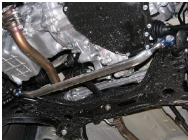
[ロアアームバー フロント] KAWAI WORKS製品。 左右ロアアームを繋ぎます。
