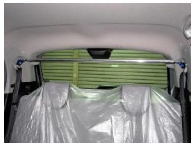
[ピラーバー ストレート] KAWAI WORKS製品。 室内左右ボディを繋ぎます。
