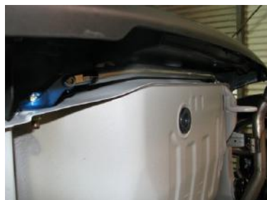
[モノコックバー リア バンパー内] KAWAI WORKS製品。 左右フレームを繋ぎます。
