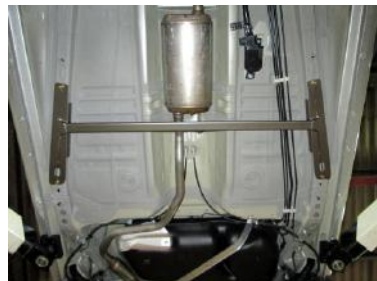
[モノコックバー センターA] KAWAI WORKS製品。 左右フレームを繋ぎます。
