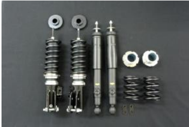
[サスペンションキット RMS-K] 前後調整式/減衰F12R14段調整式。 ストリートからミニサーキットまで幅広い カテゴリーをターゲットにしたサスペン ションキット。
