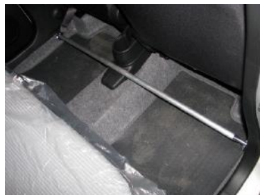
[フロアバー] KAWAI WORKS製品。 室内左右フレームを繋ぎます。
