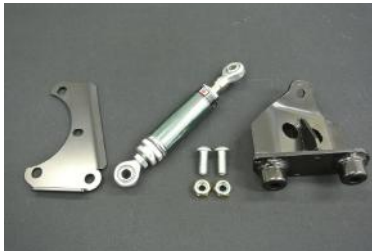
[エンジンリンクダンパー] エンジンとボディをオリジナルダンパーで 連結し、効果的にエンジンの振動を抑制 します。
