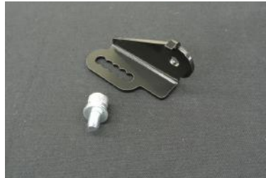
[オートレベライザーセンサーステー] 車高変更等により狂ってしまう光軸を センサー取付位置を変更することにより 補正が可能です。
