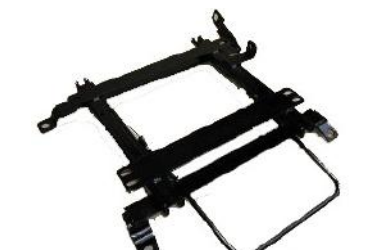
[純正レカロ用ローポジションレール] 純正レカロシートをローポジションさせる ことができます。30mmダウンタイプと 70mmダウンタイプ設定あります。
