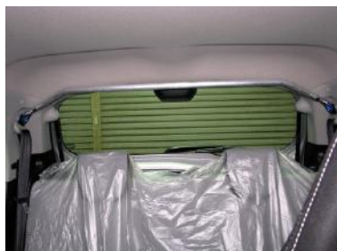
[ピラーバー スクエア] KAWAI WORKS製品。 室内左右ボディを繋ぎます。
