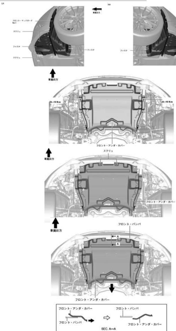
■左図を参照の上アンダーパネル類を取り外します。
