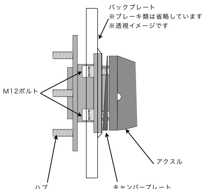
■球面ワッシャーをセットしたM12ボルトを取り付けバックプレートとキャンバープレートを介しアクスルに取付けます。
