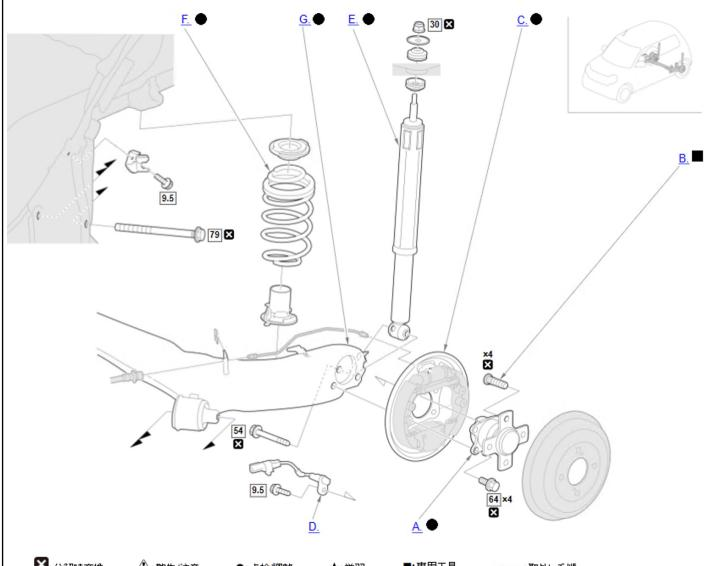
■リアタイヤを外し、サイドブレーキを解除してブレーキドラムを取り外します。
