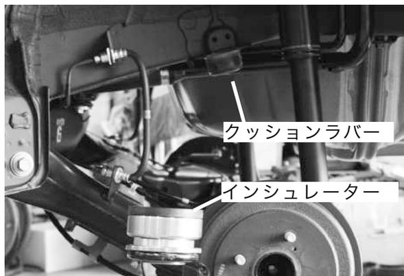
■リアショックアブソーバーの下側のボルト&ナットを外しリアスプリングとインシュレーターを取り外します。
