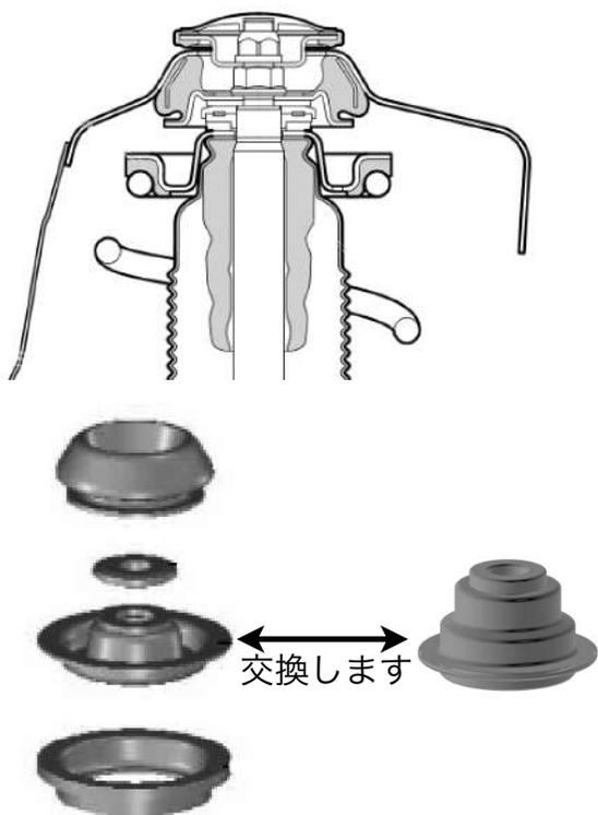
■フロントストラットを車体から取り外しスプリングコンプレッサーを使用しストラットを分解します。
