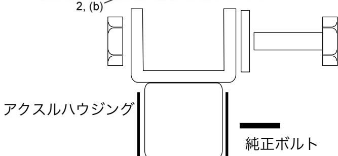
■ショックアブソーバーのロアマウント部に延長プラケットを装着し仮締めの状態で車体に装着します。
