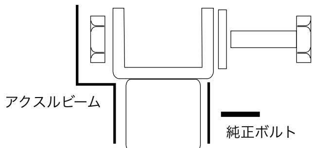
■ショックアブソーバーのロアマウント部に延長プラケットを装着し仮締めの状態でアクスルビームに装着します。
