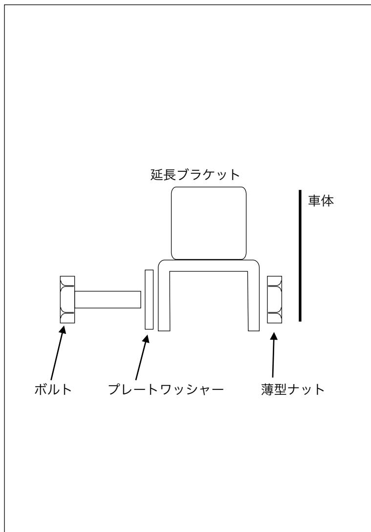
■ショックアブソーバーのトップマウント部に延長ブラケットを装着し仮締めの状態で車体に装着します。ショックアブソーバーが全伸状態で車体側取り付けボルトとアクスル側取り付けボルトの直線上にトップマウント部が来るよう延長ブラケットを固定します。(1)タイヤを装着しリジットラックから車両を下ろした状態でゴムブッシュ部を締め付けます。(2)※付属のボルト、ワッシャー、薄型ナットは左図のように組み付けてください。誤った配置の場合延長ブラケット背面と車体の隙間が少ないので干渉することがあります。
