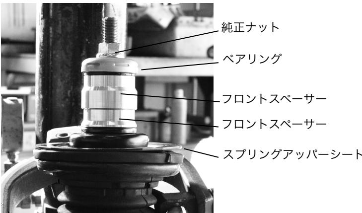
■スプリングコンプレッサーを使用してフロントスプリングを圧縮します。ゴムマウントとベアリングを外しスプリングアッパーシートの上にフロントスペーサーを入れ、ベアリングとゴムマウントを元に戻します。
