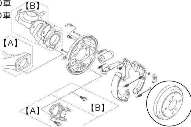
■2WD車・4WD車とも○で囲んだブレーキドラムを交換します。
