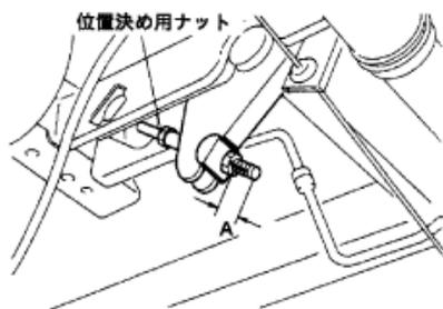
■アンカーアームのナットを緩めてナットとアンカーアームブロックを取り外します。
