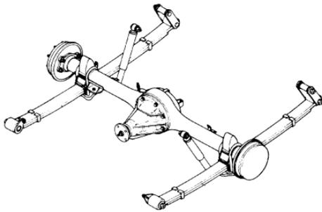
■フロントダブルウィッシュボーン/リアリーフリジットアクスルの構成です。フロントトーションバーアンカーナットの脱着及び調整が必要です。リアはシャックルの交換が必要です。
