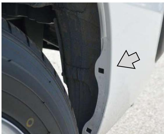
■車両を洗車されることをおすすめします。両面テープと接触する部分はケミカル用品を使用して脱脂して下さい。脱脂が不十分な場合両面テープの接着力が弱まる場合があります。
