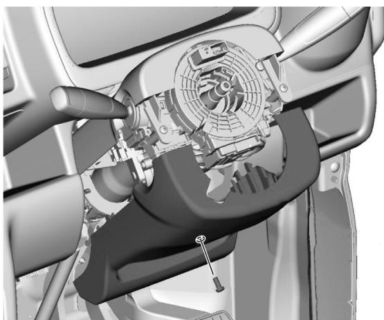
■ステアリングコラムカバーを止めているビスを外し、コラムカバーを外します。
