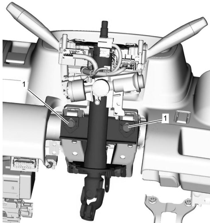
■ステアリングコラムを締結している左図1のボルトを取り外します。
