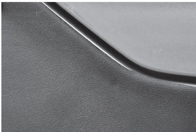
■シボ仕上げ（表面に凹凸を施しています）
