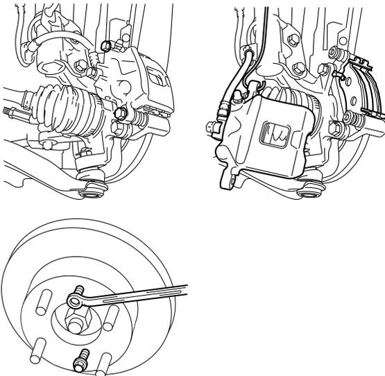
■ フロントハブナックルよりキャリパーピンボルト、ブレーキキャリパー、スライドピン（ダストブーツ）、ブレーキパッド、ブレーキパッドシム、キャリパーサポートを取り外しブレーキディスクをキットのものと交換します。
