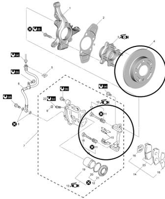
■○で囲んだブレーキディスクとキャリパーサポートを交換及びパーツの移し替えをします。
