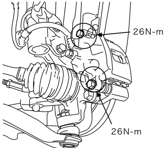
■取り付けは逆の手順で行います。ブレーキパッドの残量インジケータはピストン側で上側です。
