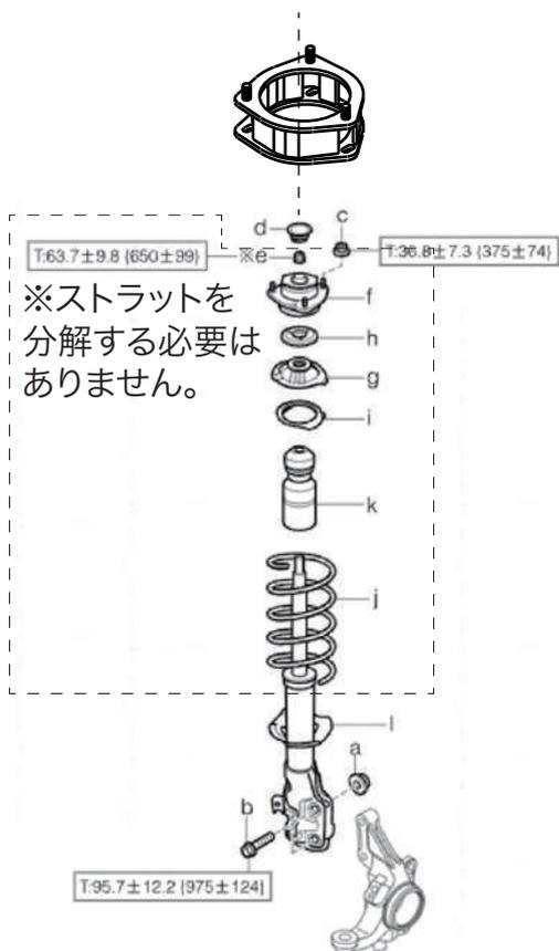
■ストラットアッパーマウントにスペーサーを取り付け(左図矢印部)、ストラットを車体に取り付けます。
