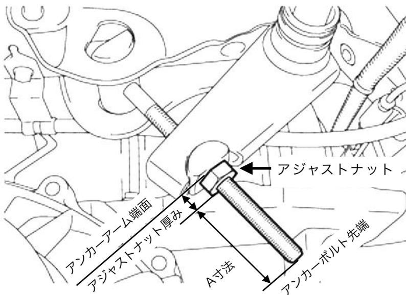
※作業前にアンカーアーム端面とアンカーボルト先端間の寸法 = アジャストナットの厚み+A寸法を計測しておきます。
