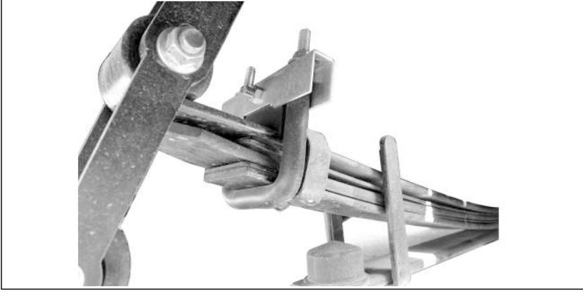
■リーフクランプをリーフスプリング後方側（シャックル側）の元のリーフバンドの後方に取り付けます。
