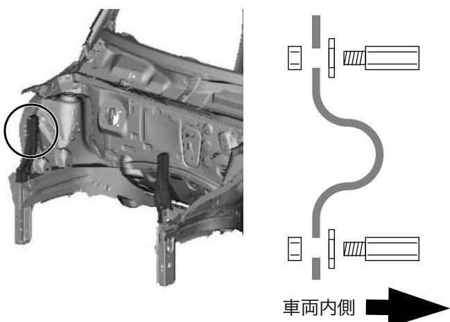
■ランプサポートブレース(Rh)にM6スペーサーボルトをプレートワッシャーを介して取り付けます。
