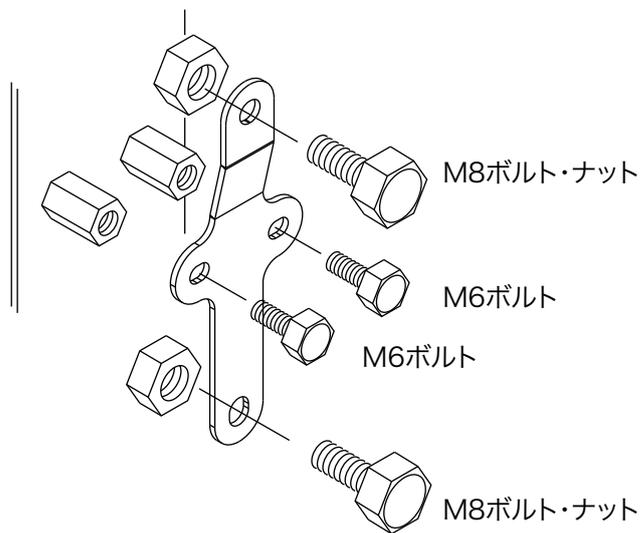
■M6ボルトでホーンステーを前工程で取り付けしたM6スペーサーボルトに取り付けます。アース端子もステーと共締めします。ホーンとホーンステーはM8ボルトナットで締結します。
