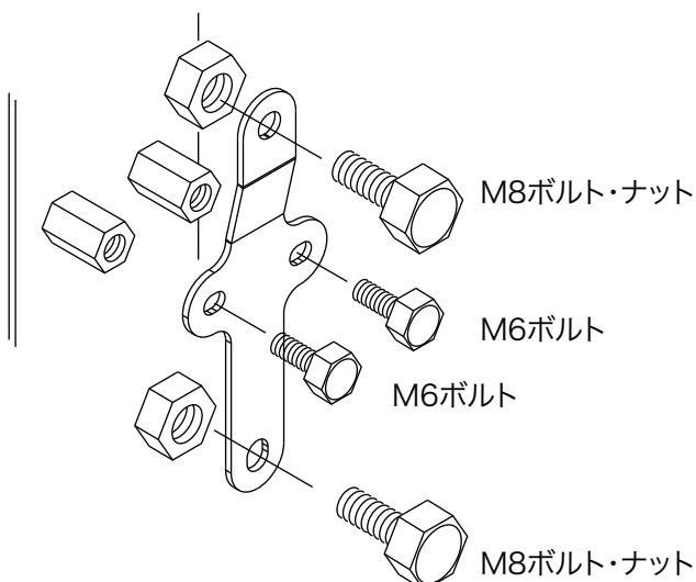
■M6ボルトでホーンステーを前工程で取り付けたM6スペーサーボルトに取り付けます。アース端子もステーと共に締めします。ホーンとホーンステーはM8ボルトナットで締結します。
