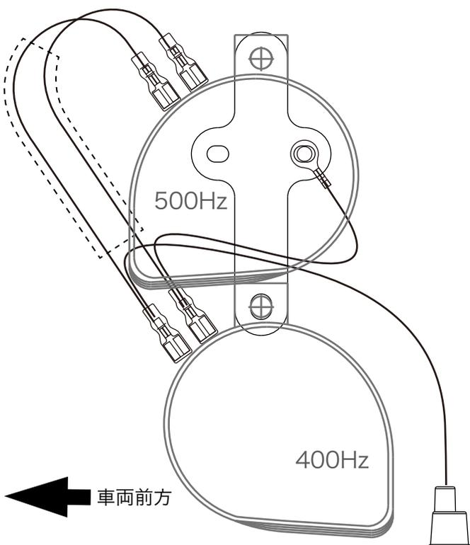
■500Hzホーンを上側400Hzホーンを下側に取り付けます。配線は左図を参照の上取り付けして下さい。
