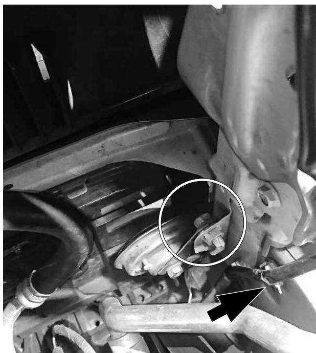
■左図○で囲んだボルトを外し純正のホーンを一旦取り外しホーンハーネスとホーンを分離します。純正ホーンは元の取り付け位置に戻しても外したままでもかまいません。
