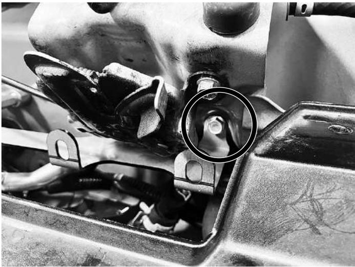
■フードラッチを取り付けているパネルの奥側のブランク穴(○部)を利用してM6ボルト&ナットでホーンステータを取り付けます。
