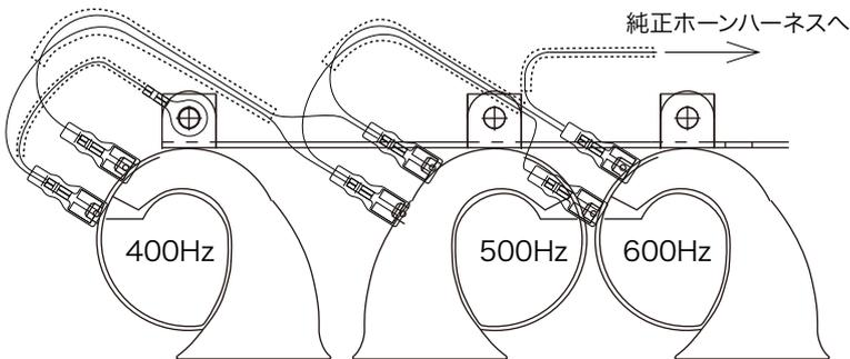
■M8ボルト&ナットでホーンステータとホーンを取り付けます。最も右側のホーンとアース端子を共締してください。ホーンは左図を参照の上取り付けてください。
