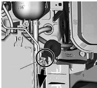
■デガッシングタンク(クーラントリザーバータンク)の下方に純正ホーンがあります。フロントバンパーの上部のボルトとクリップを外して純正ホーンからコネクタを外します。
