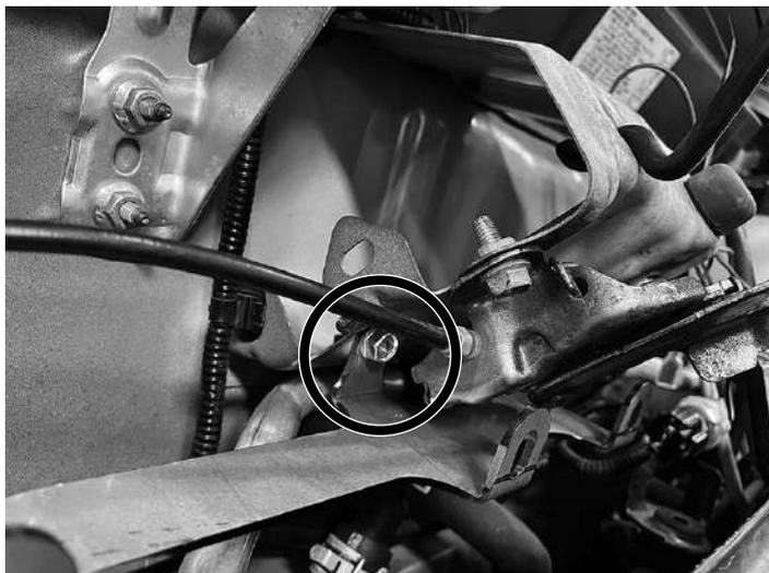
■フードラッチを取り付けているパネルの奥側のblank穴(○部)を利用してM6ボルト&ナットでホーンステーを取り付けます。フードラッチからハーネスが出ているグレードの場合ハーネスの挟み込みに注意してください。
