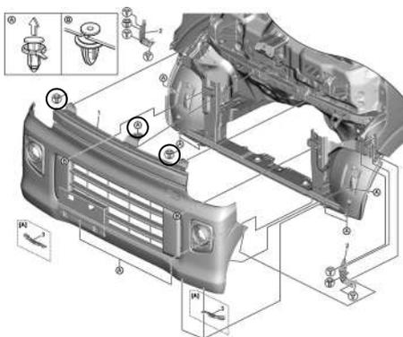
○で囲んだボルト×2とクリップ×1を外して純正ホーンにアクセスします。
