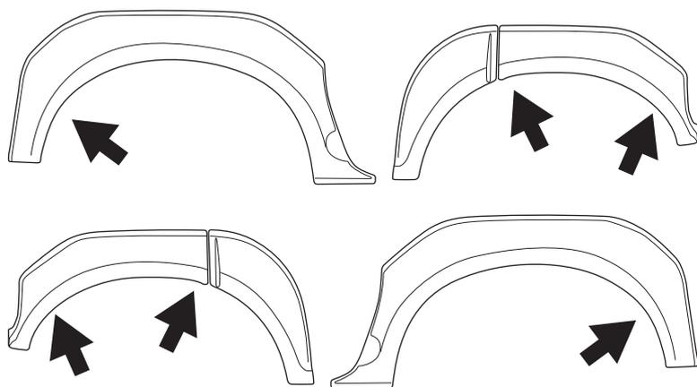
■車両を洗車されることをおすすめします。両面テープと接触する部分はケミカル用品を使用して脱脂して下さい。脱脂が不十分な場合両面テープの接着力が弱まる場合があります。
