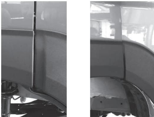
■ドア部はドア開閉に伴う干渉回避のために逃がし部分を設けてあります。
