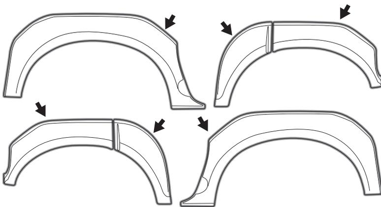
■両面テープ部分がボディにきちんと接着されているかどうか確認して下さい。位置の修正等で一度貼付けたフェンダーエクステンションを外した場合は両面テープの再使用は絶対にしないで下さい。当初の接着強度を得られない場合があります。
