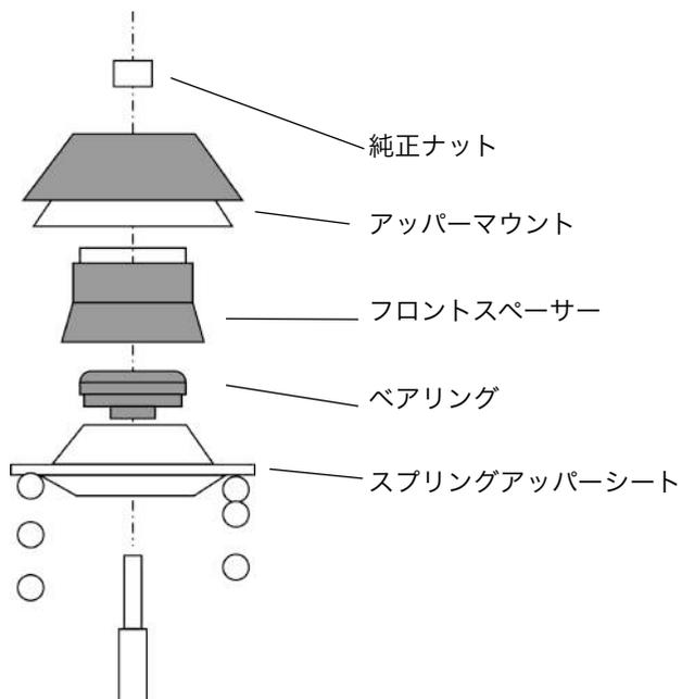
■スプリングコンプレッサーを使用してフロントスプリングを圧縮します。アップアマウントを外しベアリングの上にフロントスペーサーを入れ、ゴムマウントと純正ナットを元に戻します。
