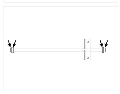
■ARSリジットキットの本体に手順2で取り外した、ラックエンド/ブーツ/リヤタイロッドを取り付けます。※本製品のブーツ取り付け部(→部)はクリップの溝を2重に設けてあります。年式によってブーツの径が2タイプあります。内側の42中が後期用、外側の38中が前期用になります。尚、前期モデルでも補修の為、後期のARSアクチュエーターに交換されている車両もある様です。ブーツの径に合わせて固定して下さい。
