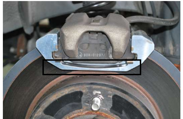
ブレーキパッドのサポート部分を連結
