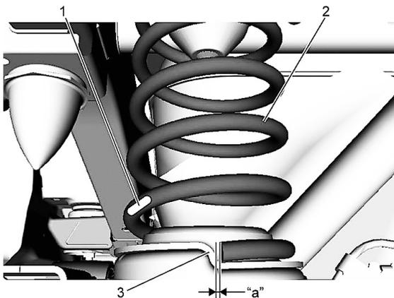
■フロント・リアとも純正のアップパー側インシュレーターは使用せず直にハイトアジャスターを車体にあてがいます。スプリングシートの凸部とスプリング内側を合わせて組み付けます。
