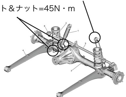
※ボルト&ナットは再使用不可部品に指定されています。新品の使用を強く推奨いたします。
