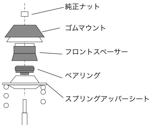
■ スプリングコンプレッサーを使用してフロントスプリングを圧縮します。ゴムマウントを外しベアリングの上にフロントスペーサーを入れ、ゴムマウントと純正ナットを元に戻します。
