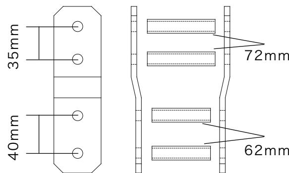
■シャックルプレートには方向性があります。穴ピッチの35mmの方が車体側、40mmの方がリーフスプリング側です。
