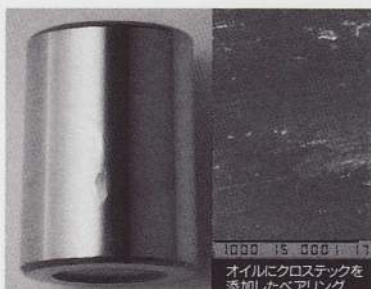
オイルにクロステックを添加したベアリング
